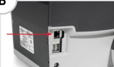
**Branchez l'autre extrémité du câble LAN dans la prise ou le routeur Internet situé sur le côté gauche du système d'affranchissement.**
