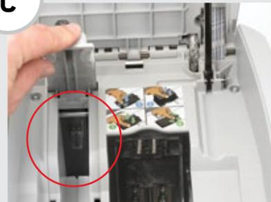
**Insérez la machine à affranchir dans le système d'affranchissement.**
